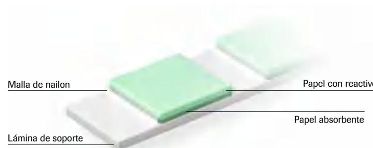
Figura 14: Estructura de la tira Combur-Test®
